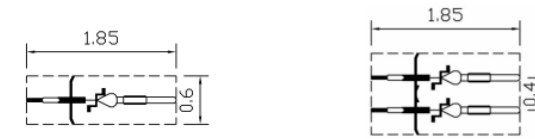
圖 5.7.1 腳踏自行車基本停車空間 (單位：公尺)
